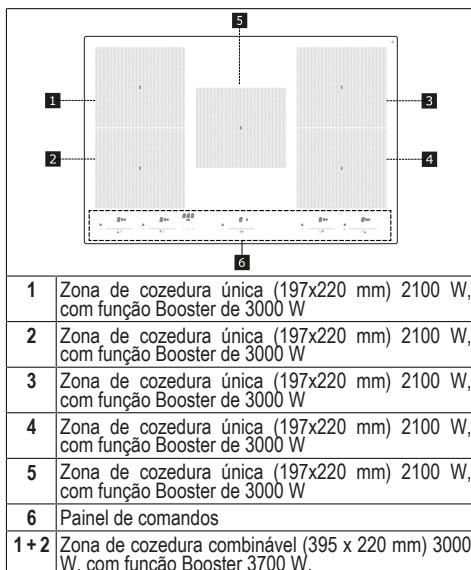
**3 + 4** Zona de cozedura combinável (395 x 220 mm) 3000 W, com função Booster 3700 W.
