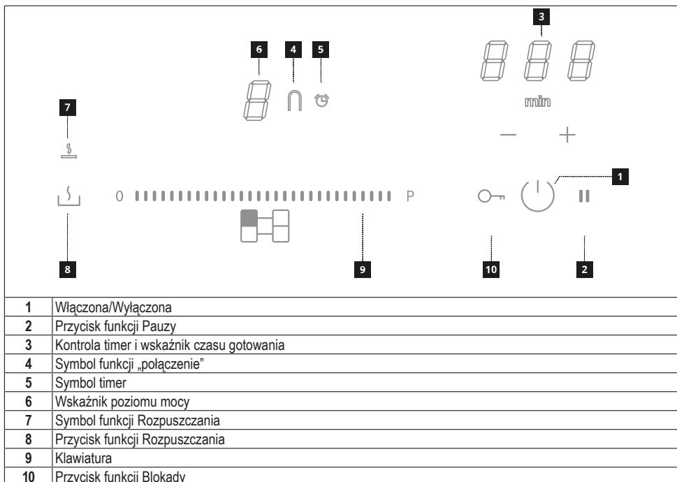
Strefy grzewcze można uaktywnić wciśkając odpowiednią przesuwaną klawiaturę. Przycisk cyfrowy podświetli się jaśniej, potwierdzając czynność.
